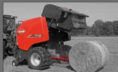
Wyrzutnik bel wykrywa, że bela jest poza zasięgiem. Tylne kłapa nie jest otwierana szerzej niż jest to potrzebne. Tylne kłapa zamyka się automatycznie
