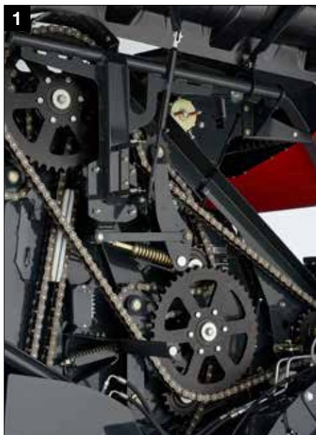
Wzmocniony układ napędowy z wytrzymałymi łańcuchami IWIS
