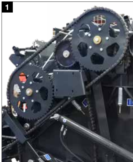
Prosty układ napędowy z jedynie 3 łańcuchami głównymi
