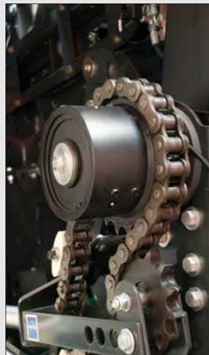
Sprzęgło zabezpieczające zespół podający INTEGRAL ROTOR
