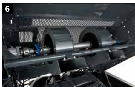
Turbiny do czyszczenia aparatów wiążących
