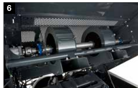
6 Turbiny do czyszczenia aparatów wiążących
