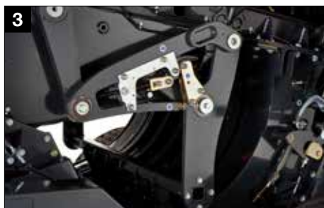
3 Komora wstępna prasowania POWER DENSITY
