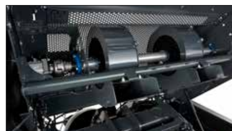
Modele z podwójnym aparatem wiążącym z hydraulicznym napędem wentylatorów
