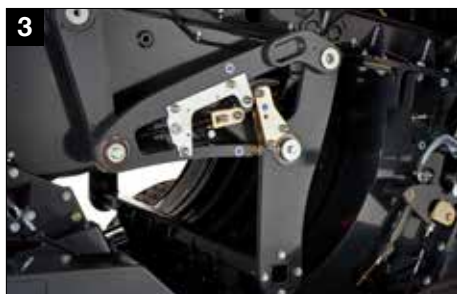
3 Komora wstępna prasowania POWER DENSITY
