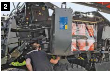
Podnoszone schowki na sznurek ułatwiają konserwację
