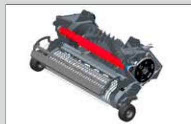
Napędzana rolka przytrzymująca pokos
