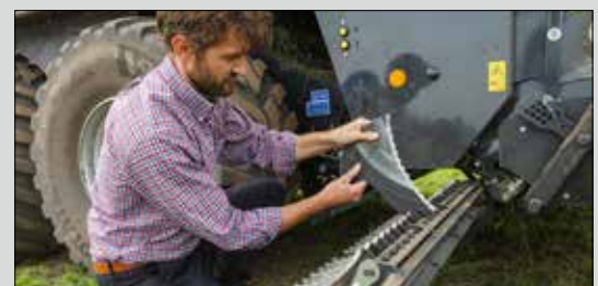
Jednostronny system kasetowy z przesuwanymi nożami
