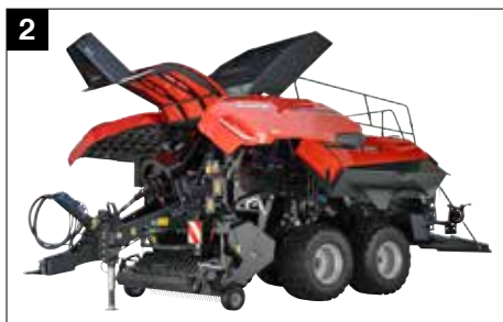
2 Podnoszone schowki na sznurek ułatwiają konserwację
