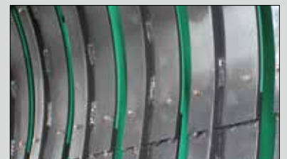
Ułatwiający przepływ płyty komory wstępnej prasy
