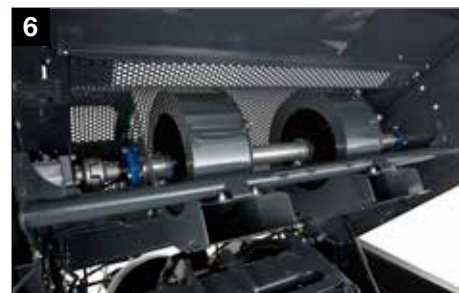
6 Turbiny do czyszczenia aparatów wiążących
