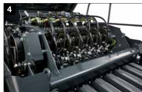
System podwójnego wiązania ze standardowym elektronicznym układem monitorującym
