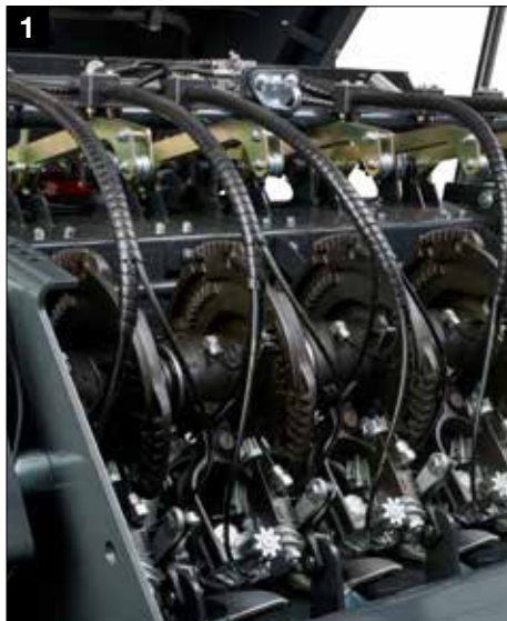
1 System podwójnego wiązania ze standardowym elektronicznym układem monitorującym
