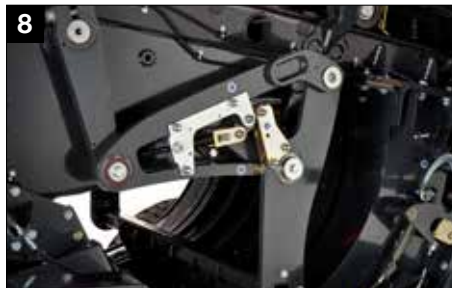
Komora wstępna prasowania POWER DENSITY
