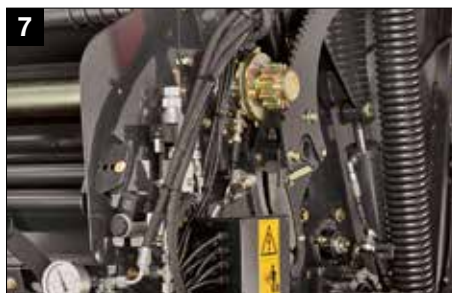
7 Zawór proporcjonalny regulujący zgniot belki z poziomu kabiny
