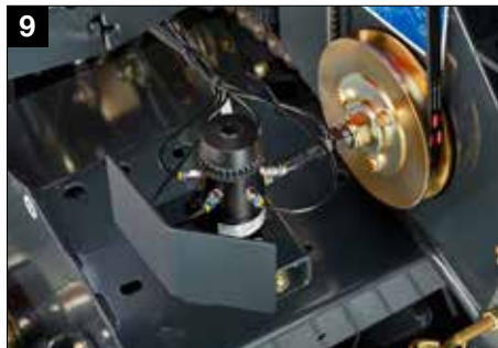
9 System ciągłego smarowania łańcucha BEKA MAX
