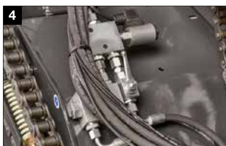
Oddzielne sterowanie nożami/opuszczaną podłogą DROPFLOOR z kabiny ciągnika
