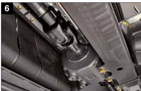
6 Wzmocnione krzyżaki wałów napędowych
