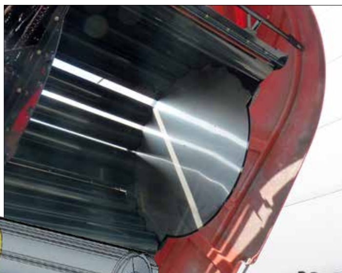
Płyty ze stali nierdzewnej o niskim współczynniku tarcia
