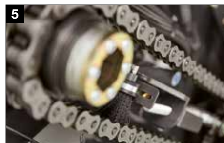
5 Solidne i szerokie szcztoki olejowe na łańcuchach: doskonale smarowanie
